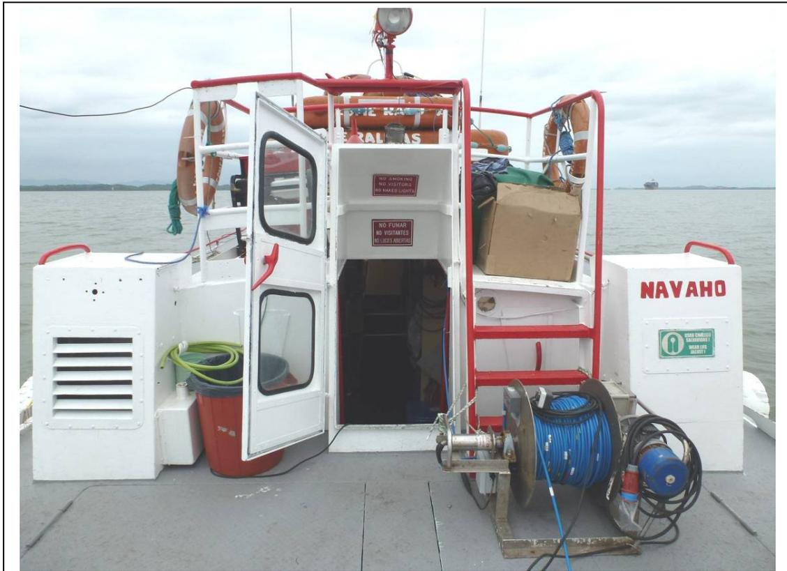
Cubierta de la embarcación "Navaho" y Winch del Sonar Lateral
