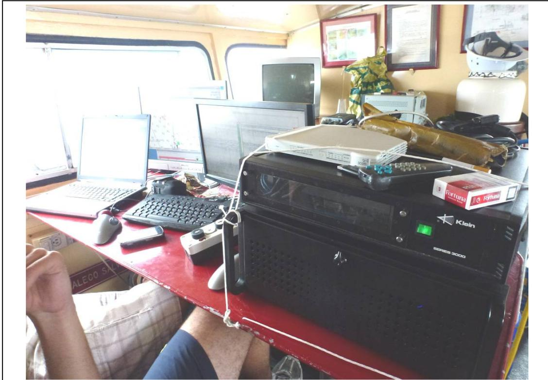
Procesador del equipo Chirp III y del Sonar de Barrido Lateral
